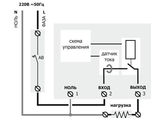
Схема 1. Схема подключения
